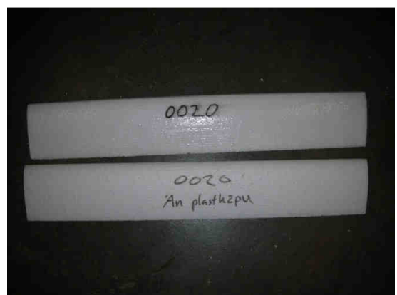
Mynd 35: NACA0020 með og án plasthúðar.
