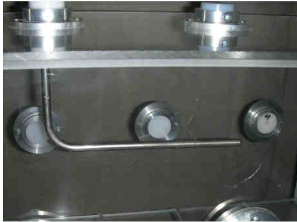
Mynd 54: Áfallsprýstimælir staðsettur í smærri vindgöngum.
